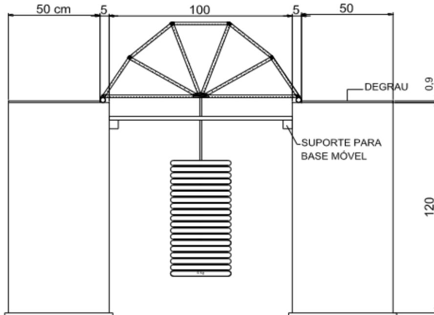
Figura 5. Teste de carga na treliça de macarrão.
