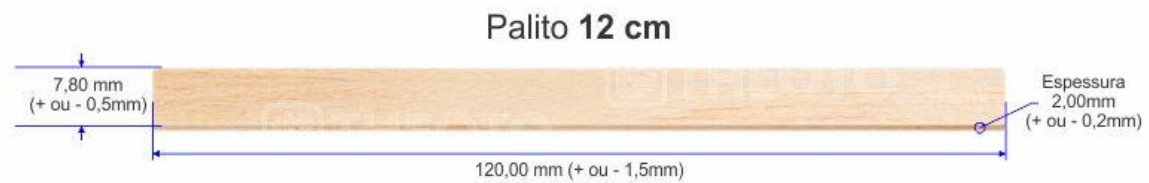
Figura 1: Dimensões do palito de picolé
